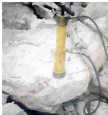
Введение в шпуров гидравлических клиньев
